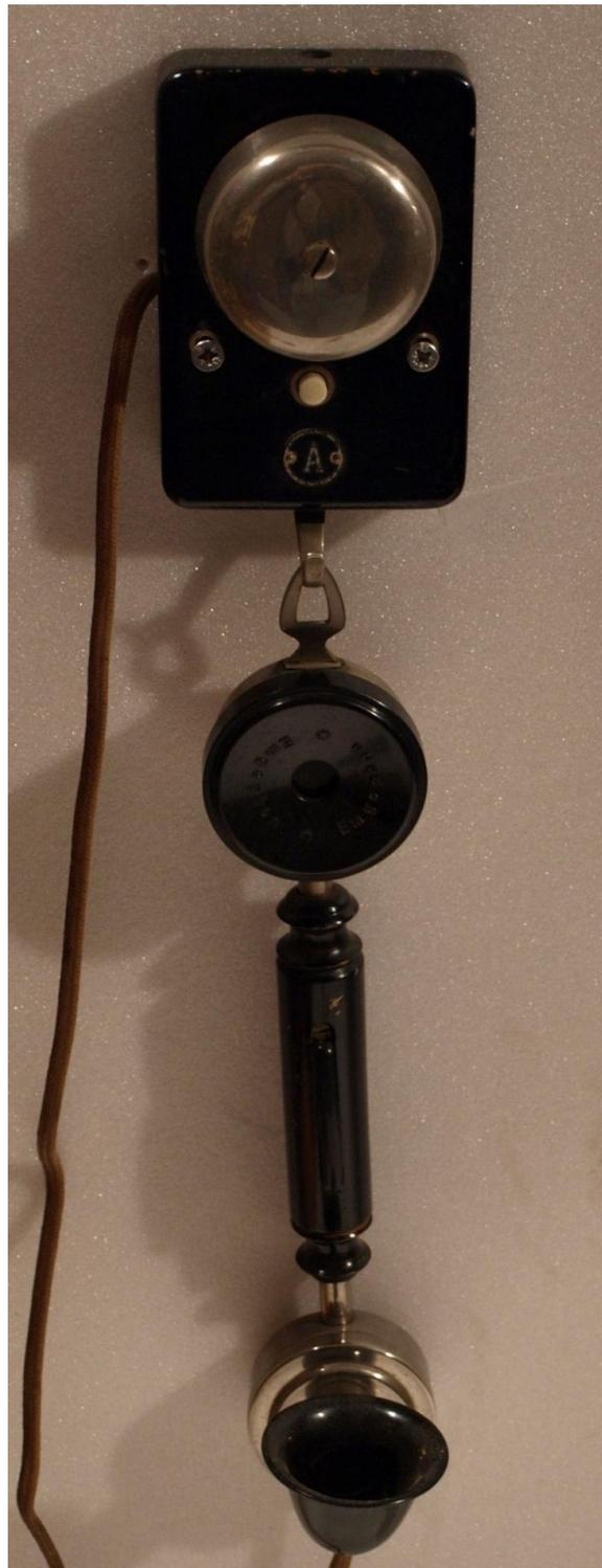
**Sprechsystem-Wandapparat, bestehend aus Sprechsystem Nr. 5202 mit Einschalter, vernickelten Metallteilen, schwarzem geriffeltem Griff und zweiadriger Schnur, schwarzpoliertem Wandbrett mit Rufknopf, Dosenwecker, verdeckten Klemmen und festem Haken D.E.G.M., welcher ein Pendeln des Mikrotelephons verhindert. Bestell-Nr. 5823, Kabelwort Adreamt. (TEFAG Katalog 1925)**
